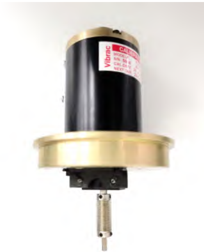
图 2.10: 扭矩传感器与联轴器安装
